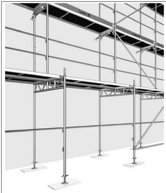
**Bild 47:** Unterste Lage mit Durchgangsrahmen
