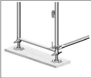
**Bild 3-1:** Last verteilender Unterbau mit Holzbohlen
