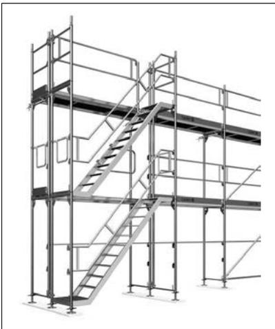
**Bild 13:** gleichläufiger Treppenaufstieg
