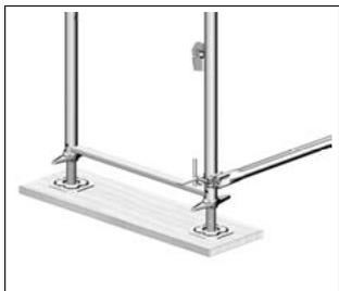
**Bild 3-1:** Last verteilender Unterbau mit Holzbohlen
