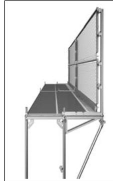
**Bild 45:** Schutzwand auf Konsole
