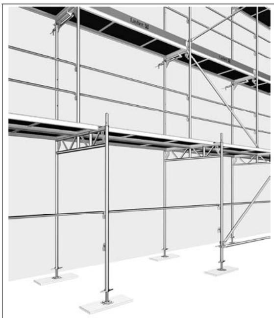
**Bild 34:** Unterste Lage mit Durchgangsrahmen
