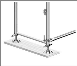
**Bild 3-1:** Lastverteilernder Unterbau mit Holzbohlen
