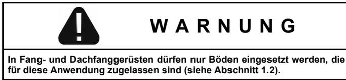
Die **Gerüstböden sind** durch die Stellrahmen der nächsten Gerüstlage bzw. in der obersten Gerüstlage durch die Geländer- oder Schutzgitterstützen **gegen unbeabsichtigtes Abheben zu sichern**. Wo dies nicht durch die darüberliegenden Bauteile erfolgen kann, **sind Belagsicherungen zu verwenden** (siehe Bild 38).
