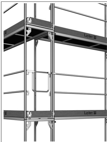
**Bild 11:** Eckausbildung (mit Drehkupplung)
