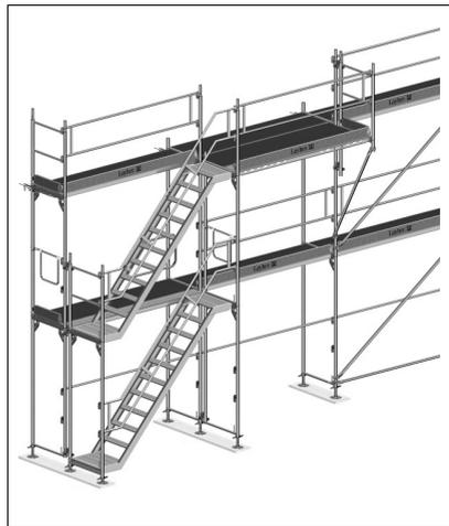
**Bild 14:** gleichlaufender Treppenaufstieg
