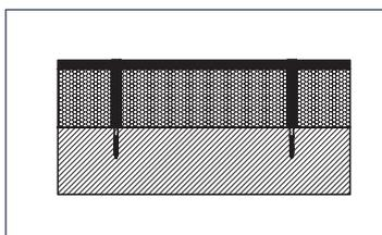
Schließen der Ankerlöcher mit Dämmmaterial (Verschlussstopfen  $\varnothing$  60 mm), Kunststoffkappe und Putz.
