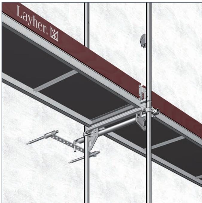
Im Hinblick auf die beabsichtigte hohe Lastübertragung am WDVS-Anker müssen einzelne Gerüsthalter am Gerüst biegesteif angeschlossen sein, wie beispielsweise durch Verwendung des Layher Blitzankers oder durch Verwendung durchgehender Anker. **Kurze, nur am Innenständer angeschlossene Gerüsthalter, sind für die Übertragung hoher Parallelkräfte nicht geeignet!**
