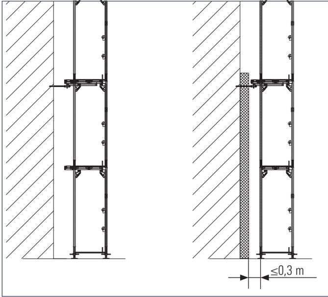
Für größere Isolierungsschichten ist die Steckkonsole 0,36 m (Art.-Nr. 1746.036) in Verbindung mit dem WDVS-Anker 800 zu verwenden. Der Ankerstab 480 ist für Isolierungen bis 300 mm ausgelegt.
