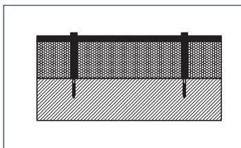
Herausdrehen der Ankerstäbe (je nach Festigkeit müssen hierzu die beiden Kontermuttern verwendet werden). Die Stockschrauben verbleiben im Mauerwerk.
