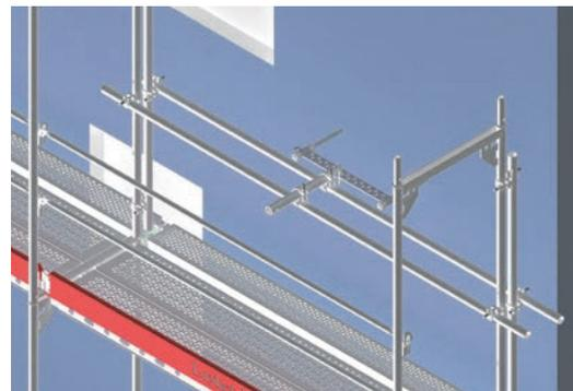
Horizontal und vertikal versetzter Anker
