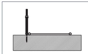
Traverse (als Bohrschablone) auf den bereits eingeschraubten Ankerstab auflegen und durch das gegenüberliegende kleine Loch die Bohrung für den 2. Ankerstab setzen.
