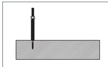
Setzen des 1. Ankerstabes in der nicht isolierten Wand (bei Bedarf mit zusätzlichem Kunststoffschlauch, siehe Seite 7).
