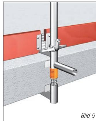
Beim Einsatz an der Decke ist die Brüstungsklammer gemäß nebenstehender Abbildung anzubringen. Allround Stiele **7** oder Blitz Geländerstiele **2** sind über die Spindel zu stecken und mit der Flügelschraube zu sichern. Des Weiteren sind Bordbretter **6** anzubringen, welche am Bordbrettbolzen der oberen Klemmbacke eingehängt werden.
