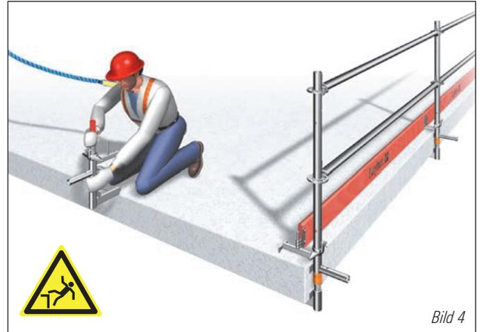
Der nächste Schritt ist das Aufstecken von Allround Stielen **7** oder Blitz Geländerstielen **2** auf den Rohrverbinder (bei Einsatz an der Attika) bzw. auf die Spindel (bei Einsatz an der Decke). Die Stiele werden nun mit Allround O-Riegeln **8** bzw. Blitz Geländern **3** (optional mit Blitz Doppelgeländern **5**) miteinander verbunden.
